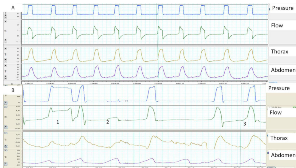
Figura 1. A) y B) Ejemplos de sincronía paciente-ventilador normal y patológica, determinados con la ayuda de bandas toracoabdominales. A) La imagen muestra una sincronía perfecta entre los movimientos tóraco-abdominales del paciente y los ciclos del ventilador (línea continua). B) La imagen muestra en el ciclo 1 un ciclado largo, presumiblemente por fuga (el paciente ha terminado de espirar mientras el ventilador sigue en inspiración) y un esfuerzo ineficaz en el ciclo 2 (movimiento de bandas sin presurización). Por último, en el ciclo 3 se observa que el inicio del ciclo del ventilador está retrasado con respecto al inicio del movimiento de las bandas (retraso de trigger, más claro en la banda abdominal).
