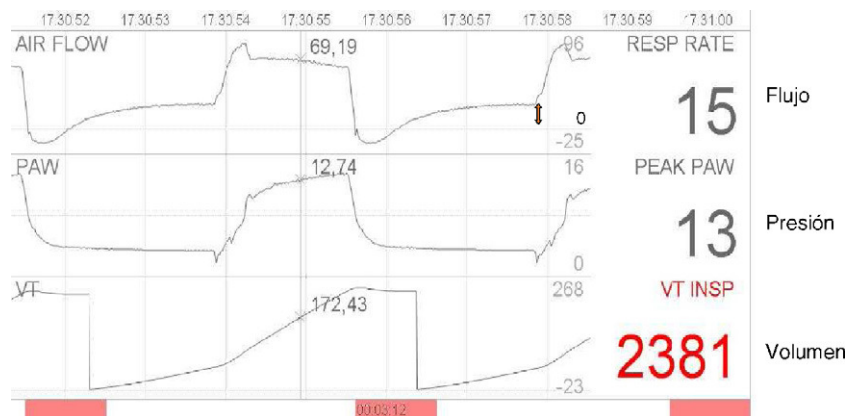
Figura 9. Método de cálculo de fugas. El sistema detecta la transición entre las pendientes de flujo espiratoria e inspiratoria. El flujo que en ese momento circula por el neumotacógrafo (flecha doble) es considerado por el sistema como flujo de fugas.
