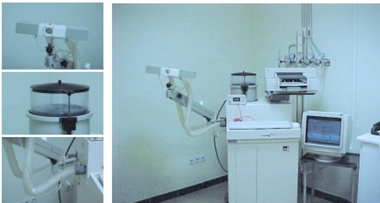
Fig. 1. Espirómetro Collins GS. Las ampliaciones indican las zonas de toma de muestra microbiológica: caja de válvulas, tubuladura proximal y campana.
