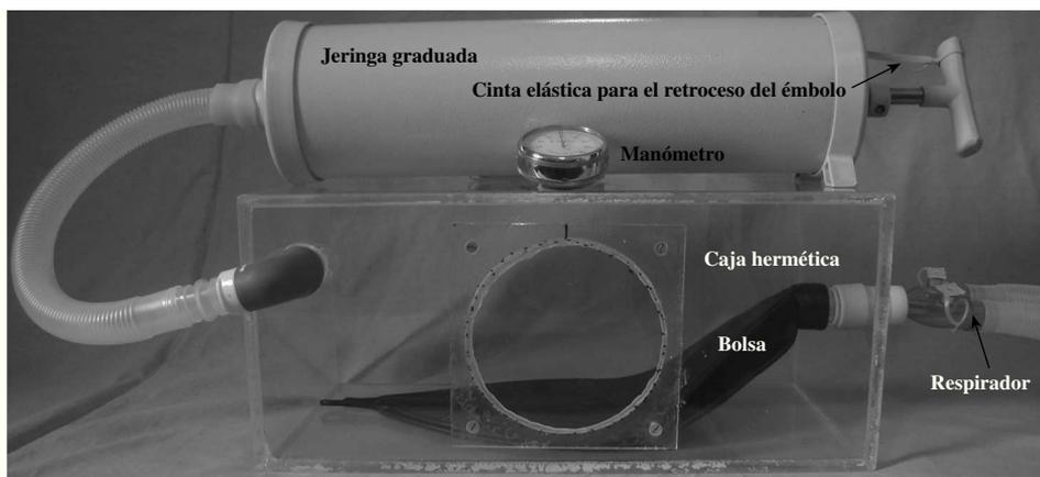
Fig. 1. Sistema de *bag-in-box* como simulador pulmonar. La bolsa, de 2 l, se conecta al ventilador, y la caja, de 8 l, a una jeringa de calibración de 3 l con retroceso elástico del émbolo.
