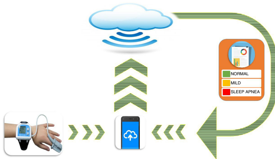
Figura 1. Esquema de un sistema escalable de pulsioximetría utilizando algoritmos basados en redes neurales para el diagnóstico de SAHOS en niños.
